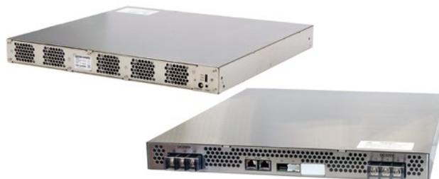
EZAシリーズは双方向の電力変換を行う絶縁型DC-DCコンバータです。シリアル通信により、電圧、電流の制御が可能です。電力変換の方向は通信による外部制御の他に、入出力電圧を監視しながら自己判断する自律運転も可能です。太陽光発電、小型風力発電を使った蓄電池システム、モーターなどのエネルギー回生システムに最適です。
